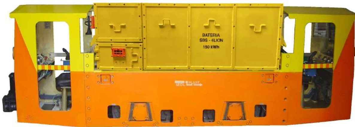
Lokomotywa typu ELA-44/* wraz z baterią typu SBS-4Lion
