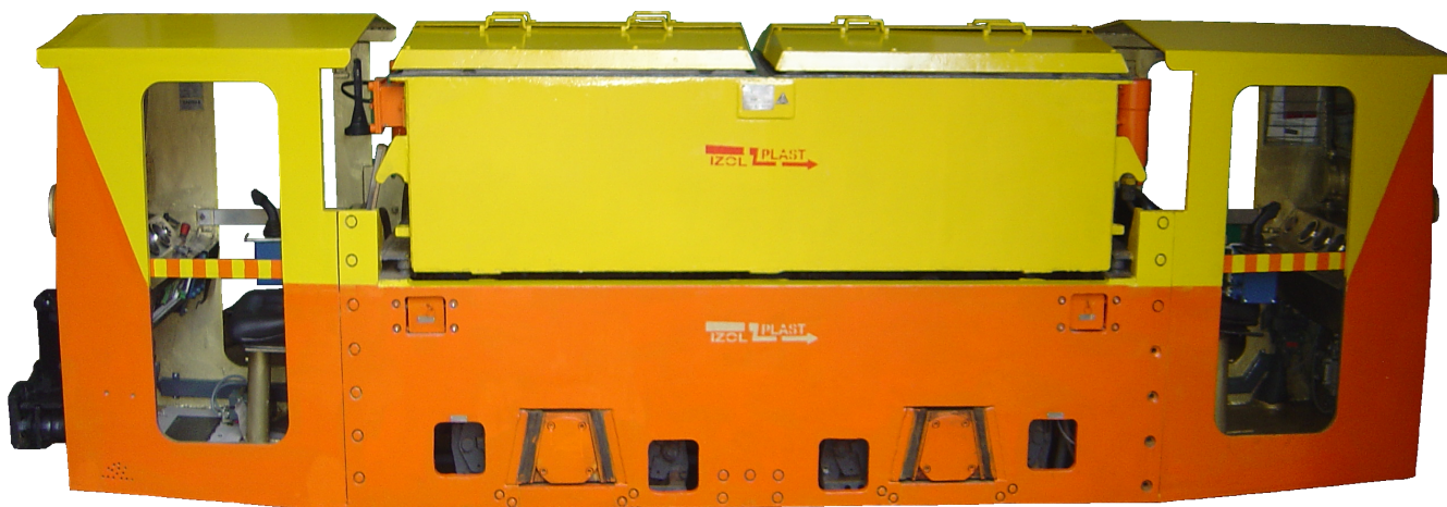
Lokomotywa typu ELA-44/* wraz z baterią typu SBS-4W
